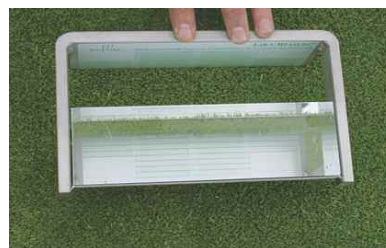
Měření výšky trávníku speciálním zrcátkem nebo metrem.
